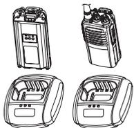
将待充电池或对讲机插入充电座上，插入插座前请关闭对讲机。
